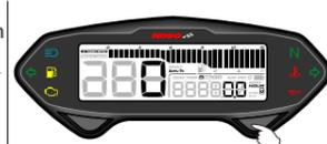
● Drücken Sie auf dem Stundenzähler-A-Bildschirm die **Einstelltaste**, um zum Stundenzähler-B-Bildschirm zu gelangen.
