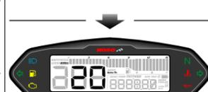
● Drücken Sie auf dem Bildschirm Durchschnittsgeschwindigkeitsaufzeichnung die **Einstelltaste** einmal, um zum Kilometerzähler-Bildschirm zu gelangen.
